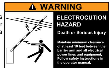
Asegúrese de que no existan cables de alto voltaje a una distancia menor de 10 ft de altura por arriba del brazo levantado de la barrera.
